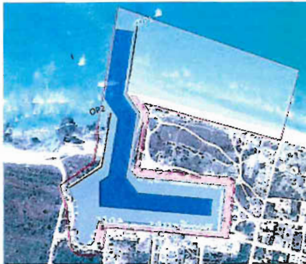
Figura 51. Áreas de agua y obras de protección del Recinto Portuario El Cuyo.
